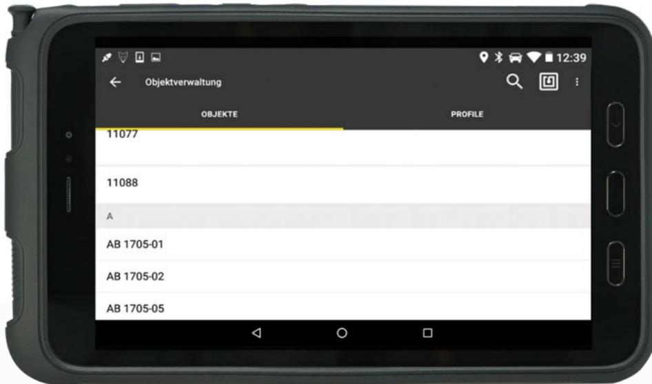
1. Das jeweilige Objekt kann einfach via Barcode oder NFC-Tag identifiziert werden. Alternativ steht auch eine Listenansicht zur Verfügung, aus der manuell ausgewählt werden kann.
